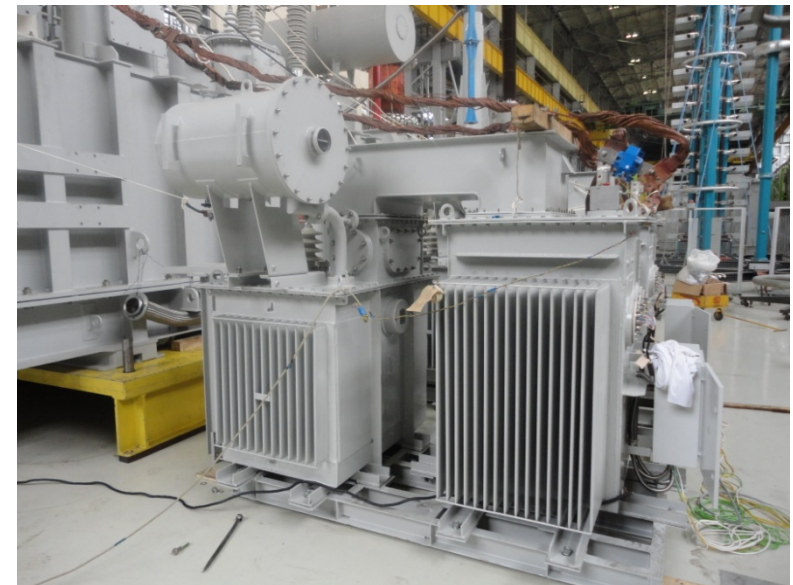
Retificador a semicondutores com transformador de alimentação
